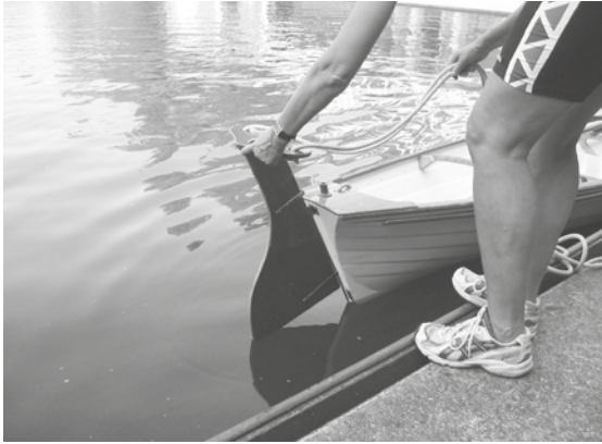
Figuur 2 Het roer en de bevestiging aan achtersteven van de boot.
